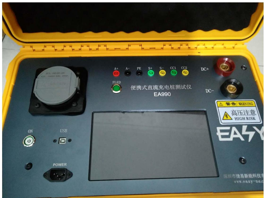
测试仪上有 1000V250A 的直流枪座，并将 9 孔枪座全部引出至面板，所有接口与枪座都是直通连接，并具有电池电压模拟功能。用户操作时应特别注意使用安全，切勿直接触摸任何高要部分。非专业人士请勿使用。否则本公司概不负任何责任。
